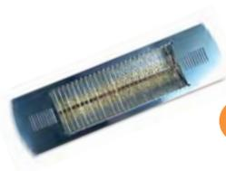
Ideal geeignet z. B. als Terrassenstrahler bzw. für Anwendungen im Außenbereich (Raucherplätze, Skihütten, Gastronomie) da spritzwassergeschützt. Leistungsstarker, kurzweiliger und tauschbarer Halogenheizstab, Reflektor mit geprägter Oberfläche, Edelstahl-Schutzgitter, Schutzklasse I, Schutzart IP24, für waagrechte Wand- oder Deckenmontage, Verlängerungsprofil siehe Zubehör, Mindestmontagehöhe 2,5 m. **Farbe:** Stahlblechgehäuse anthrazit lackiert
